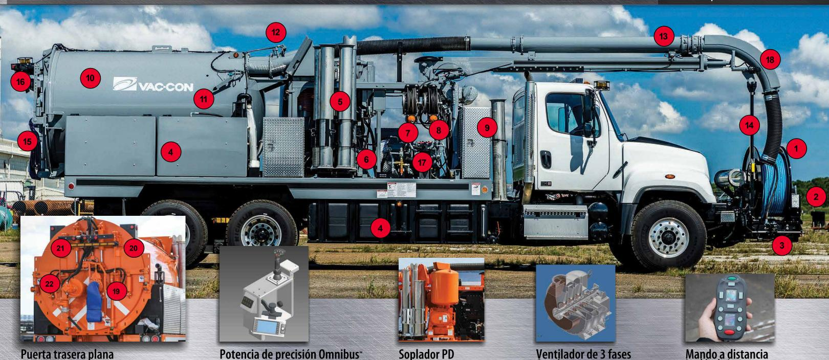
La puerta trasera de estilo plano incluye una válvula de cuchillo de 6 in, iluminación de barras de flechas y bomba desactivada.
